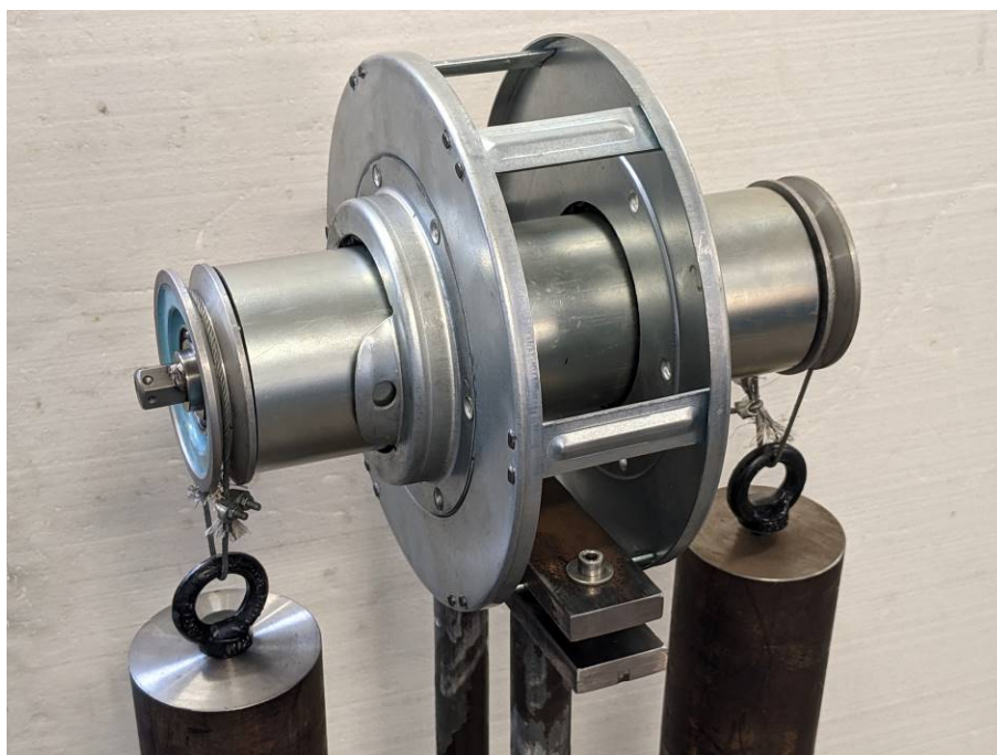
Foto N°10 – Scatola portamolla 280x101 con sfere nylon Masinara
