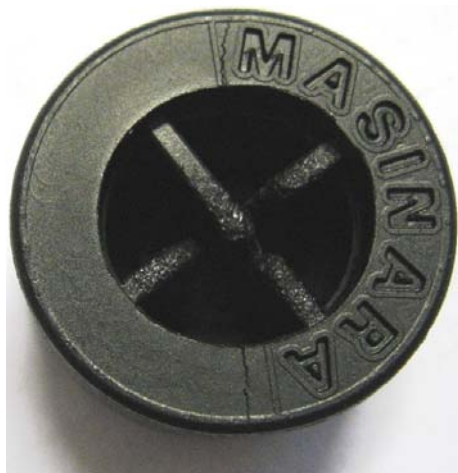
FOTO N° 6 Dopo -30° C: Inizio rottura a 256 daN (=251.14Kg)
