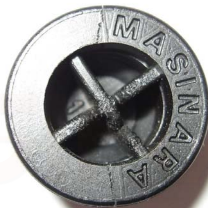
Photo N. 4 T.A. 25°C: Début rupture à 266 daN (=260.95Kg)
