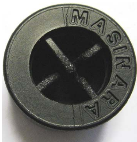
Photo N. 6 Après -30° C: Début rupture à 256 daN (=251.14Kg)
