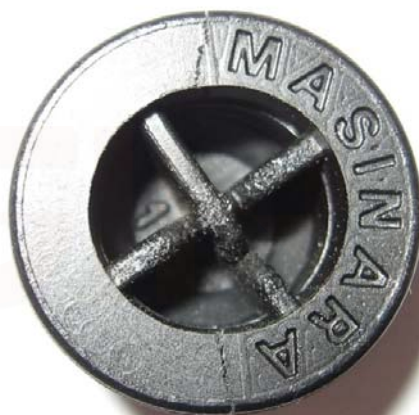
FOTO N° 4 T.A. 25°C: Inizio rottura a 266 daN (=260.95Kg)
