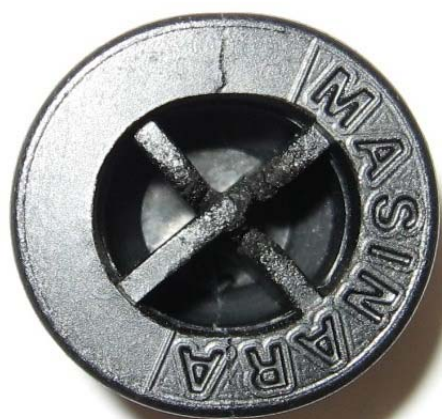
Photo N. 4 T.A. 25°C: Début rupture à 266 daN (=260.95Kg)
