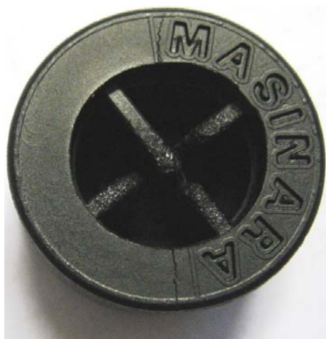
DIBUJO N° 6 Dopo -30° C: Inizio de rotura a 256 daN (=251.14Kg)
